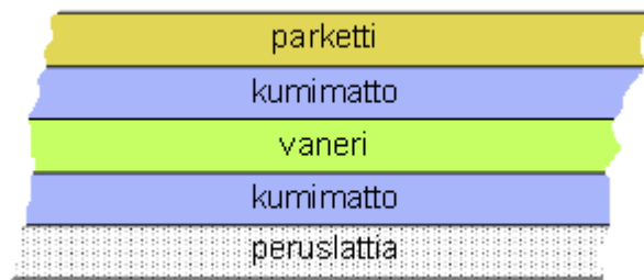
Kuva 7c - Halvempi vaihtoehtoinen ratkaisu kelluvaan lattiaan.
